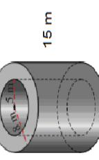
15.- Calcula el coste de fabricación de la chimenea de hormigón de la figura, sabiendo que el precio del hormigón y mano de obra es de 50 €/m<sup>2</sup>.
